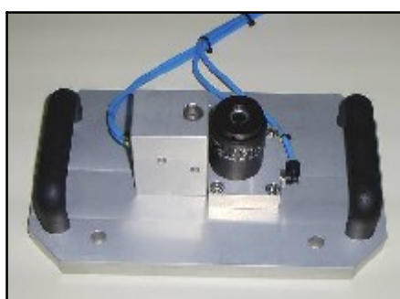
Posages de Soufflage (Evacuation des Impuretés – Logique Pneumatique)
