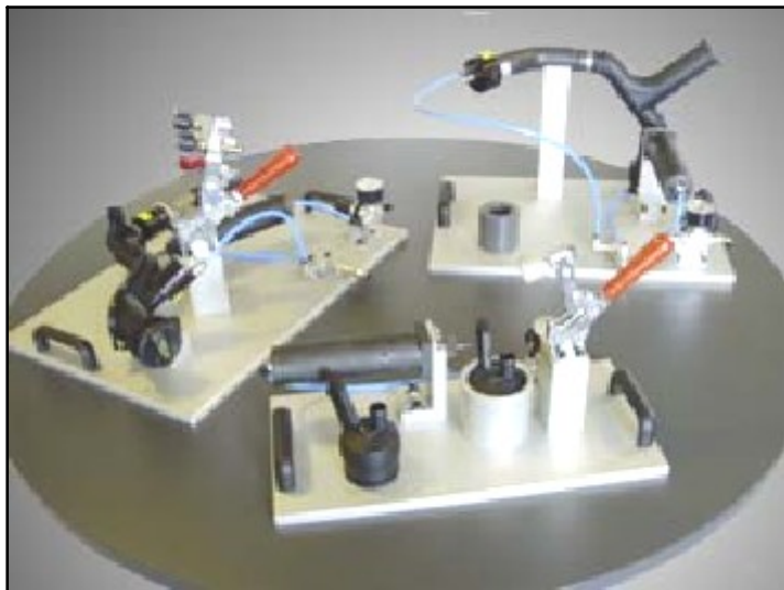
Posages Contrôle Reniflards (Système gonflant, Marquage Automator & Bridage Manuel)
