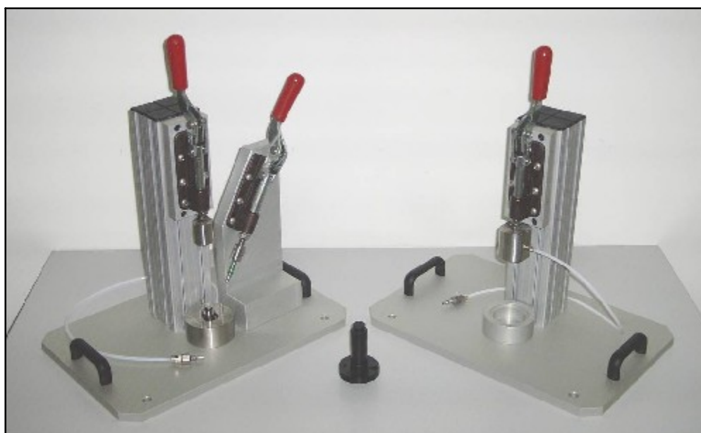
Posages Contrôle Piston (Soudure & Emmanchement Cartouche)
