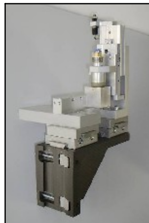
Posage Contrôle Élément Filtre (Poste pour Ligne d'assemblage)
