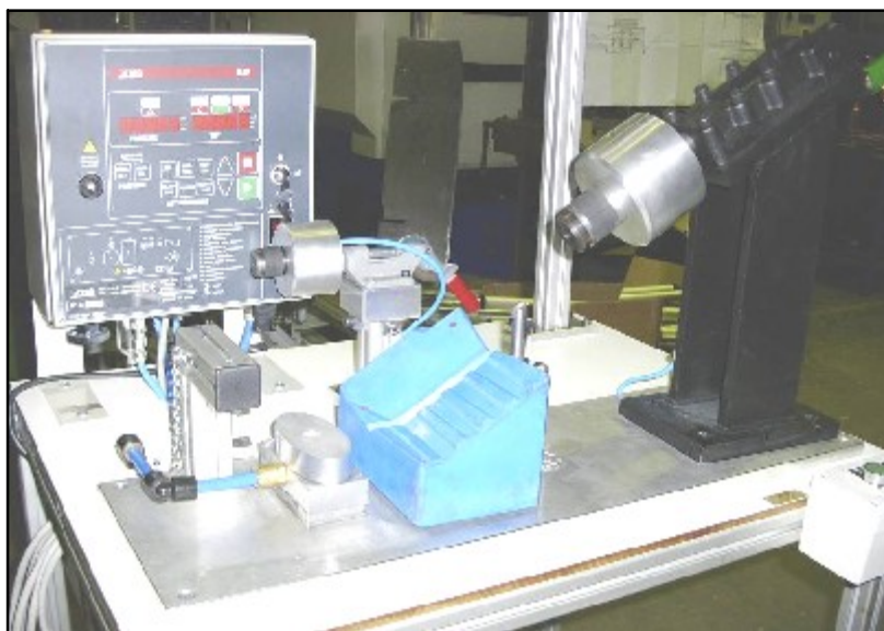
Poste Contrôle Résonateur (Soudure Conduit Intérieur puis Enveloppe Extérieur)
