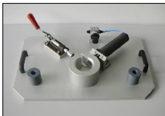
Posage Contrôle Reniflard (Avec Marquage Automator)
