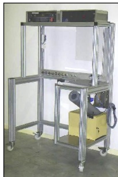
Poste de Travail (Appareil, Gestion Bouchage, Goulotte ...)
