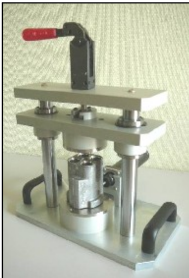
Posage Contrôle Corps (Etanchéité)
