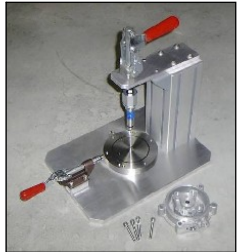
Posage Contrôle Manifold (Etanchéité)
