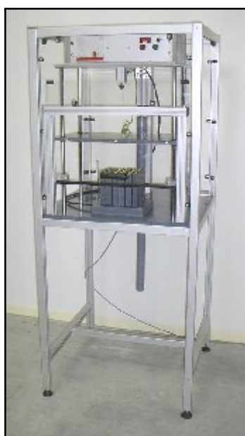
Machine de Contrôle Electrique (Appareil DCS & Support Isolant)
