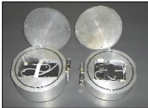
Cloches Contrôle Cellule (Etanchéité Composants Scellés)
