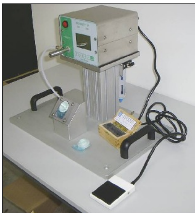
Posage Contrôle Bouchon (Avec Support Appareil)
