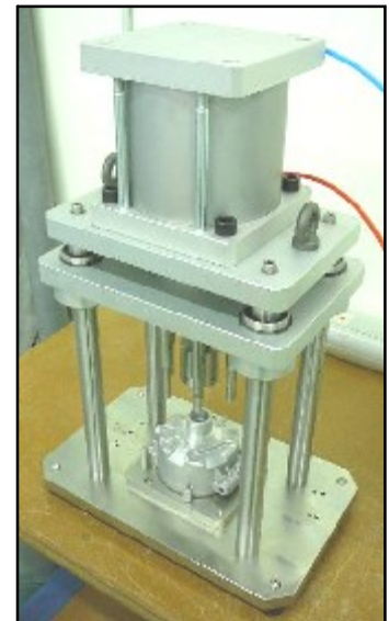
Posage Contrôle Carter (Etanchéité)
