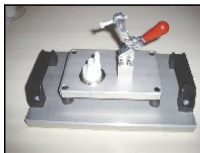
Posage Contrôle Couvercle (Cône de Précision)
